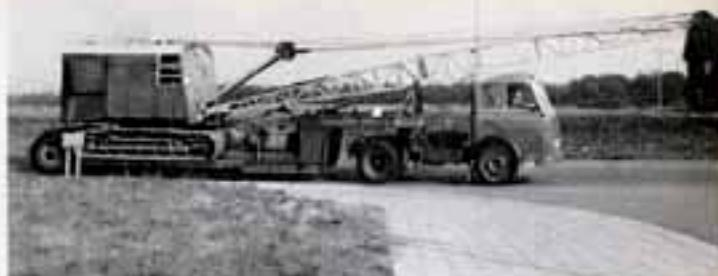
Transport von 2 Baggers mit speziell hierfür bestimmten Tiefladern
